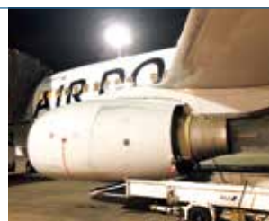
エンジン洗浄中の様子
